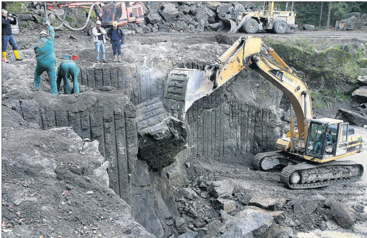
Schweres Gerät: Ein großer Bagger holt eine neue Ladung Tuffstein aus der Wand. 2500 Tonnen des Materials werden für die Sanierungsarbeiten benötigt. Fotos: Herzog
