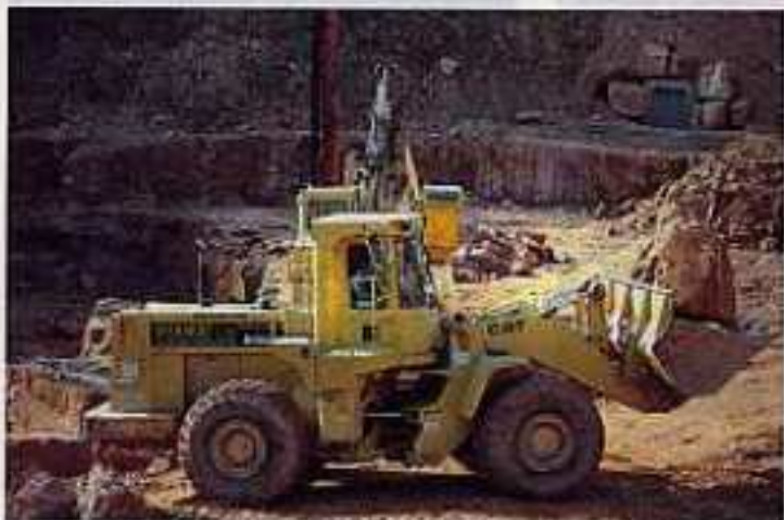
Zur Standardausrüstung einer Abbaupatrulle gehören ein Radlader, ein Schaufelbagger und ein Bagger mit hydraulischem Bohrergerät. Schubert versucht, möglichst große Blöcke abzubauen, um eine hohe Bohrbrechleistung zu erzielen.
