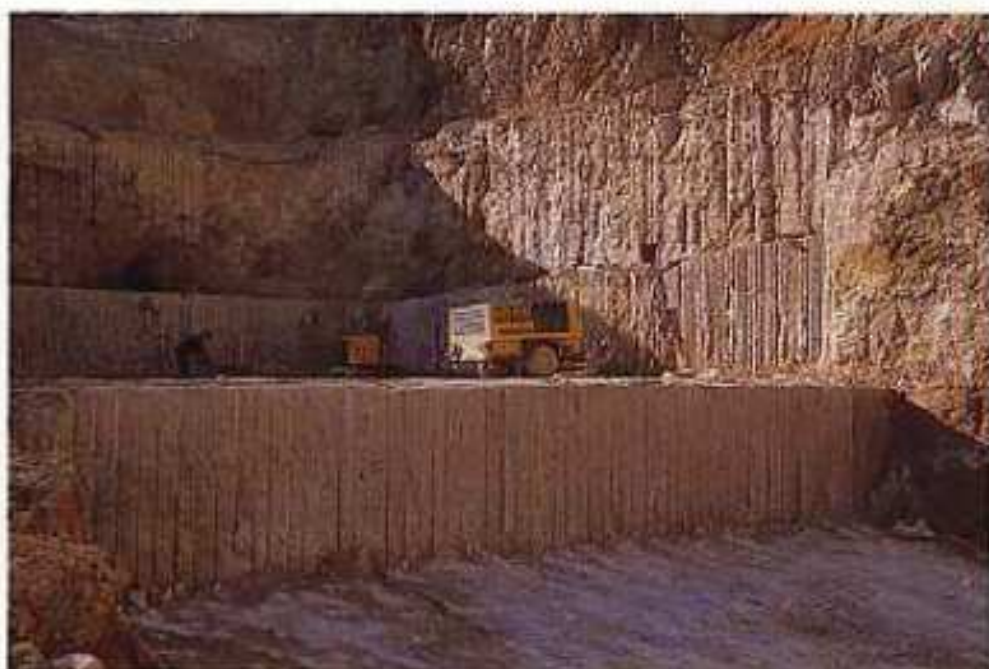
Wie hier im Kleinziegenfelder Dolomitbruch baut Schubert immer in Terrassen ab. Dadurch lassen sich gleichzeitig Steine unterschiedlicher Beschaffenheit gewinnen.
