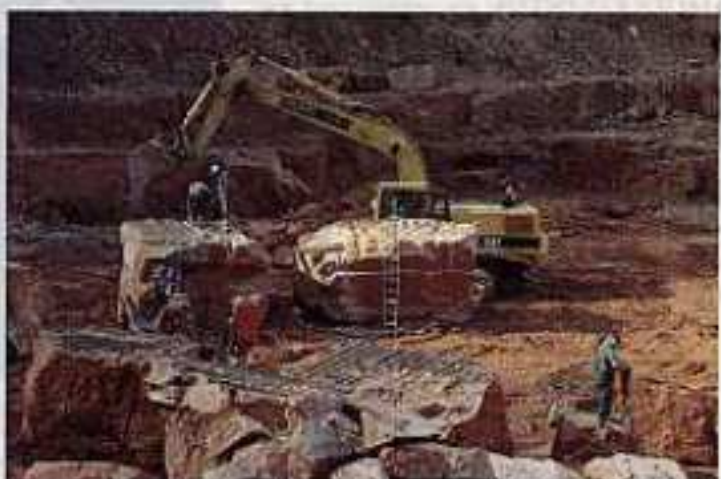
Zur Standardausrüstung einer Abbaupatrulle gehören ein Radlader, ein Schaufelbagger und ein Bagger mit hydraulischem Bohrergerät. Schubert versucht, möglichst große Blöcke abzubauen, um eine hohe Bohrbrechleistung zu erzielen.
