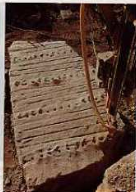
Mit dem hydraulischen Bohrergerät wird ein Block für die Teilung vorbereitet.
