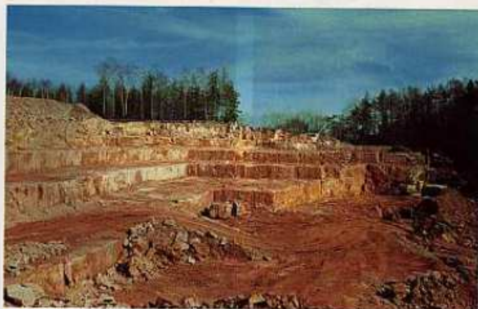
Der ROCHLITZER PORPHYR wird in Terrassen abgebaut. Dank eines schweren Bohrergeräts können zwei Sohlen auf einmal bearbeitet werden.
